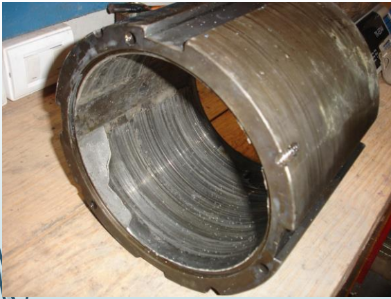
Buje de bocina de proa de buque, con gran daño por rayado.
