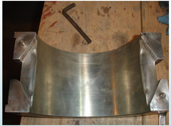
Cojinete nro. 2 de turbina AEG, de 16 MW. Se aprecia el daño por 3ros cuerpos.
