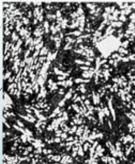
Sn-8 Sb-8 Cu ( Babbitt 3 ). Agujas de Cu 6 Sn 5 y cuboides de SbSn (ambos blancos) en una matriz de soluc. sólida rica en Sn.
