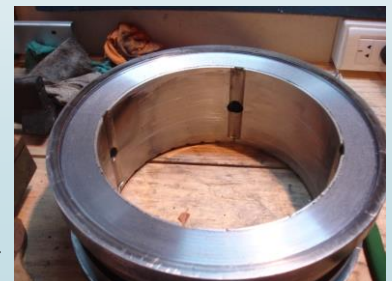
Cojinete caja reductora turbina de gas. Remoción mecánica del MB axial.
