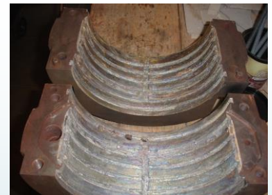
Coj. N°2 TV Ansaldo (33 MW). Remoción por calor del MB.
