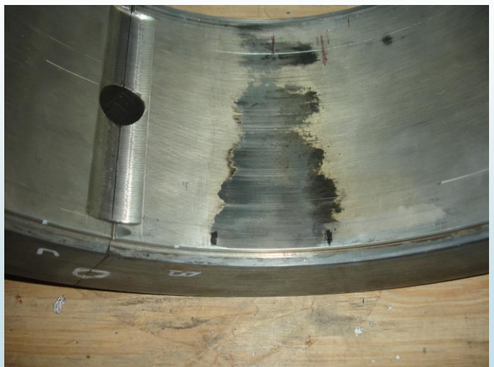
Cojinete caja reductora turbina de gas. Se aprecia el daño por 3ros cuerpos.
